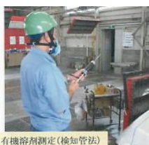
有機溶剤測定(検知管法)
